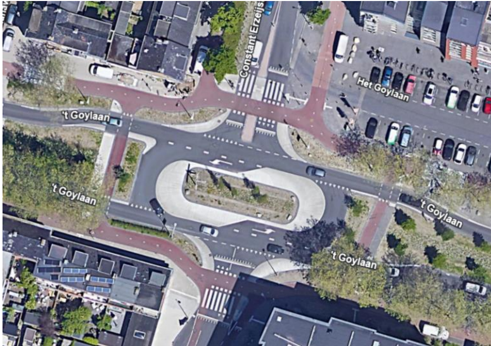
Figuur 3 Voorrangsplein 't Goylaan wordt na de herinrichting in 2020 langwerpiger en lijkt hierdoor minder op een rotonde.
