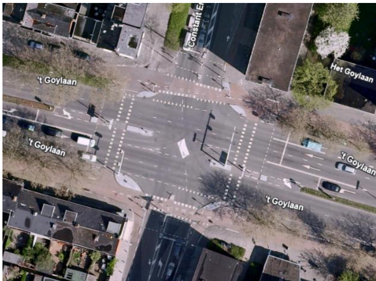
Figuur 1 De oude situatie op kruising 't Goylaan – Constant Erzeijstraat – Hooft Graaflandstraat, met tweebaanswegen en verkeerslichten.
