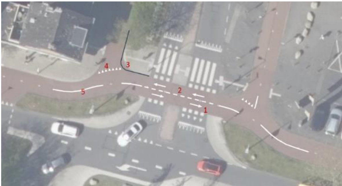
Figuur 5 Het verkeersveiligheidsproject bestaat uit vijf maatregelen op voorrangsplein 't Goylaan (corresponderend met de opsommingslijst hierboven).
