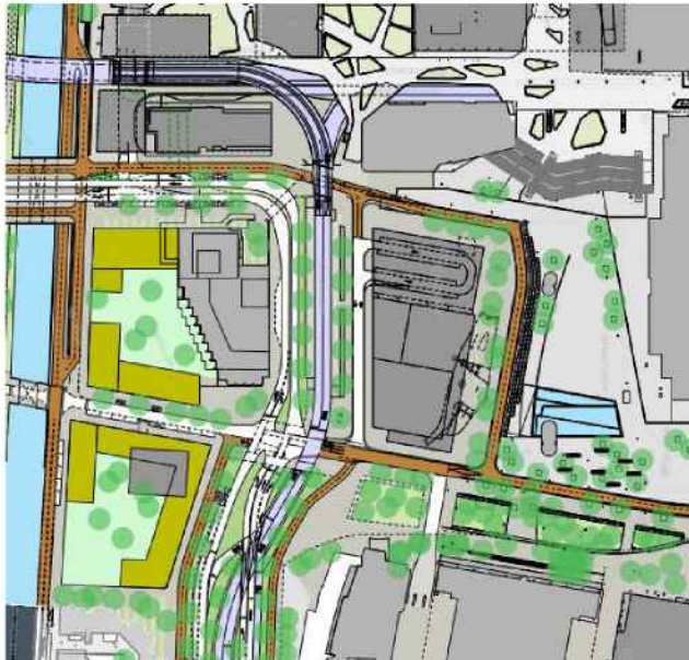
figuur 2: Uitsnede Functioneel Ontwerp Lombokplein ter hoogte van tramhalte Jaarbeursplein.
