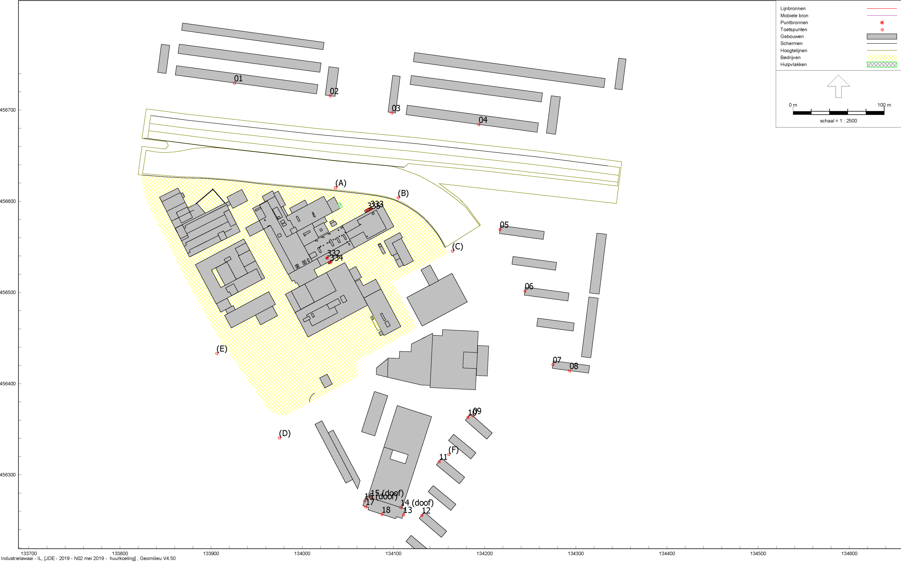
Overzicht van het rekenmodel, met de ligging van de voor de tijdelijke koeling ingevoerde geluidbronnen
