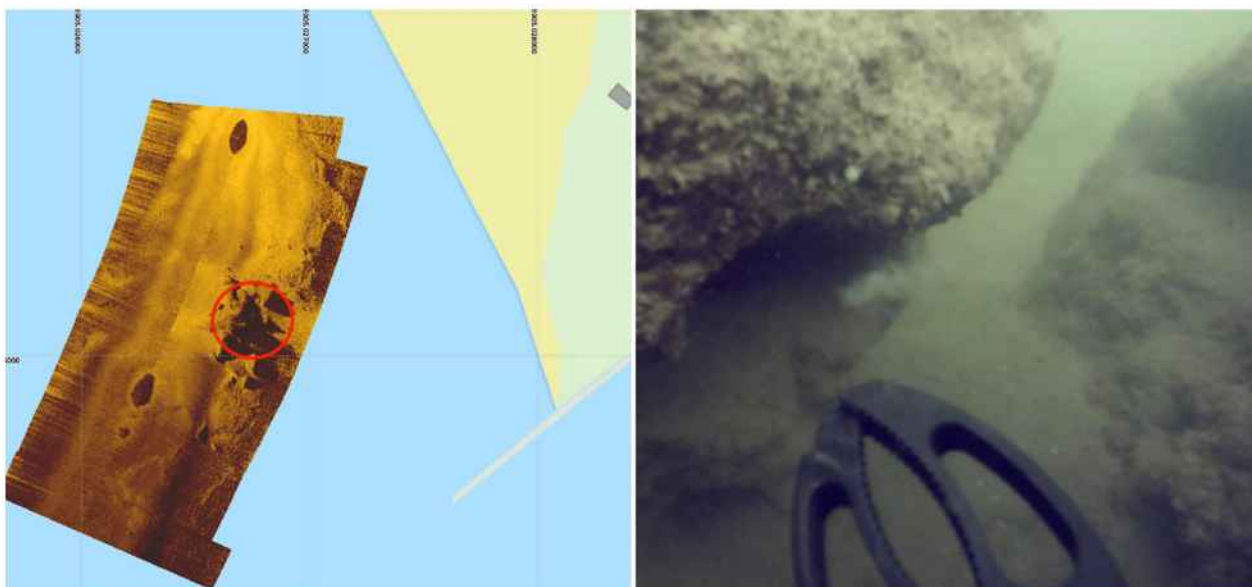
Figuur 4.1.2 Links: Sonar-scan met rood omcirkeld: bodemstructuren en foto rechts: ROV-beeld van dezelfde locatie
