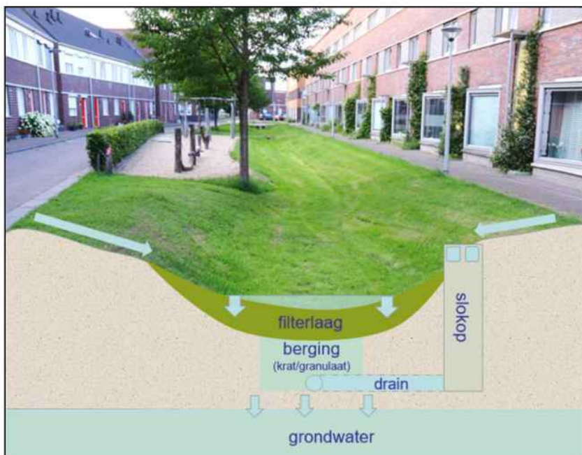
Figuur 19: Dwarsdoorsnede van een wadi. Bron: Kennisportaal Klimaatadaptatie.
