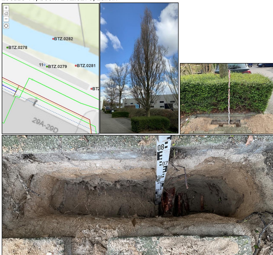
Foto 5: overzicht locatie 11 boom BTZ.0279. Sleuf is in de rand van de verplantkult gemaakt.
