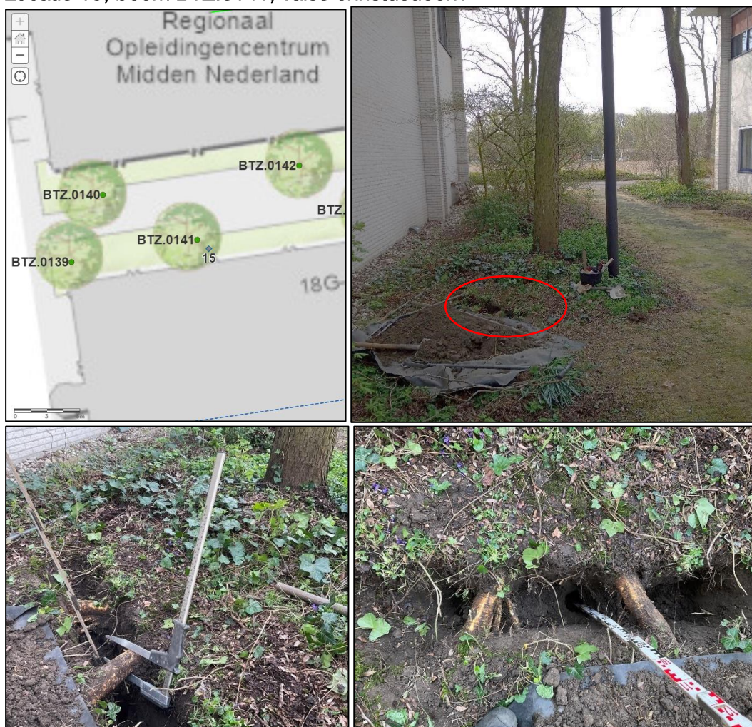
Foto 9: overzicht locatie 15. Sleuf is op de rand van de verplantkruit gemaakt (rode ovaal). Linksonder een wortel van 80 mm doorsnee.
