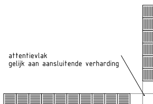
Detail: 33 Principedetail geleidelijnen; Geleiding bij hoek \geq 45^\circ SCHAAL 1 : 50
