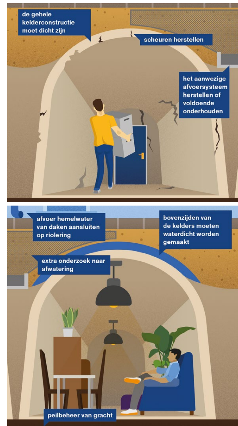
Figuur 5. Boven: aanpak voor uitsluitend behoud van het erfgoed en veiligheid. Onder: aanpak behoud van erfgoed, veiligheid en bovendien geschikt maken voor hedendaagse functies
