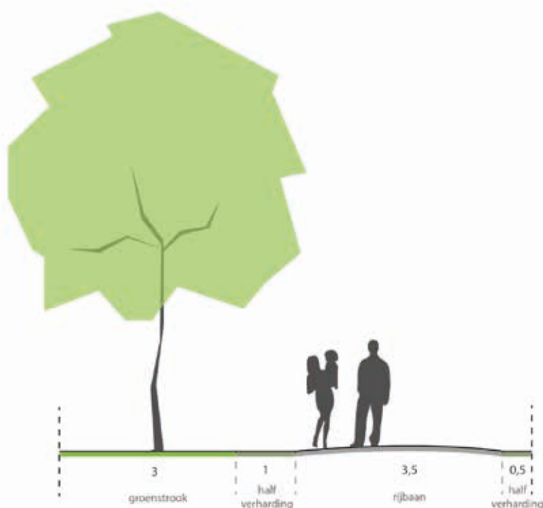
Figuur 8: Principeprofiel toegangsweg zorgcentrum
