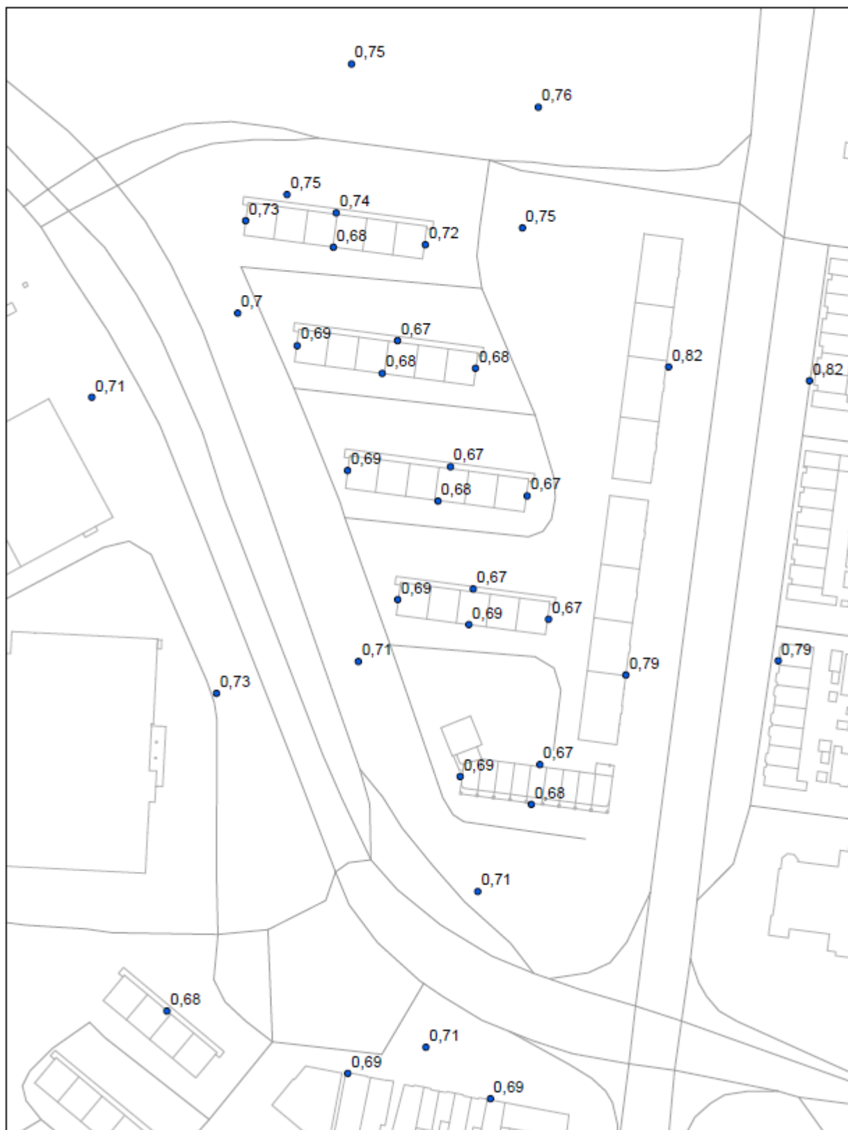
Figuur B5-3: Jaargemiddelde concentratie roet Beoogd Ontwerp 2020 in \mu\text{g}/\text{m}^3
