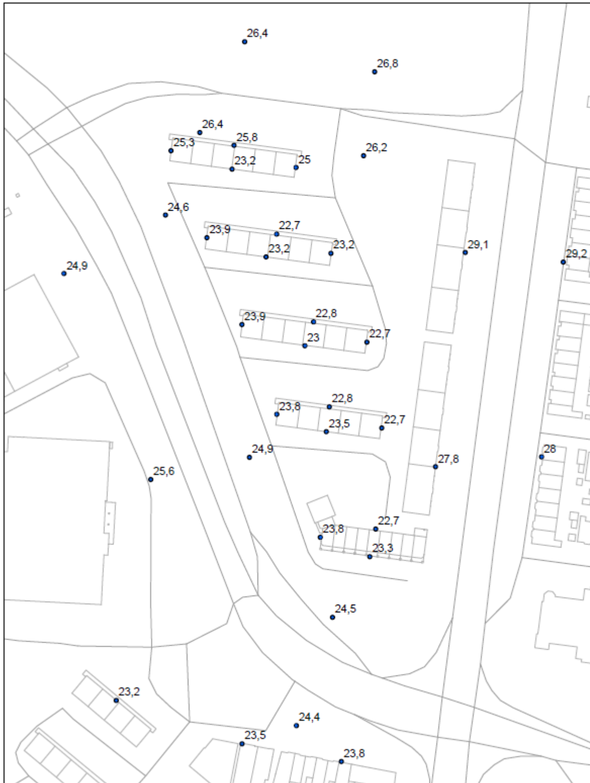
Figuur B3-3: Jaargemiddelde concentratie stikstofdioxide Beoogd Ontwerp 2020 in \mu\text{g}/\text{m}^3
