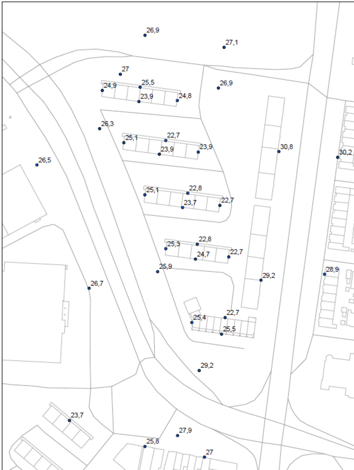
Figuur B3-2: Jaargemiddelde concentratie stikstofdioxide Autonoom 2020 in \mu\text{g}/\text{m}^3
