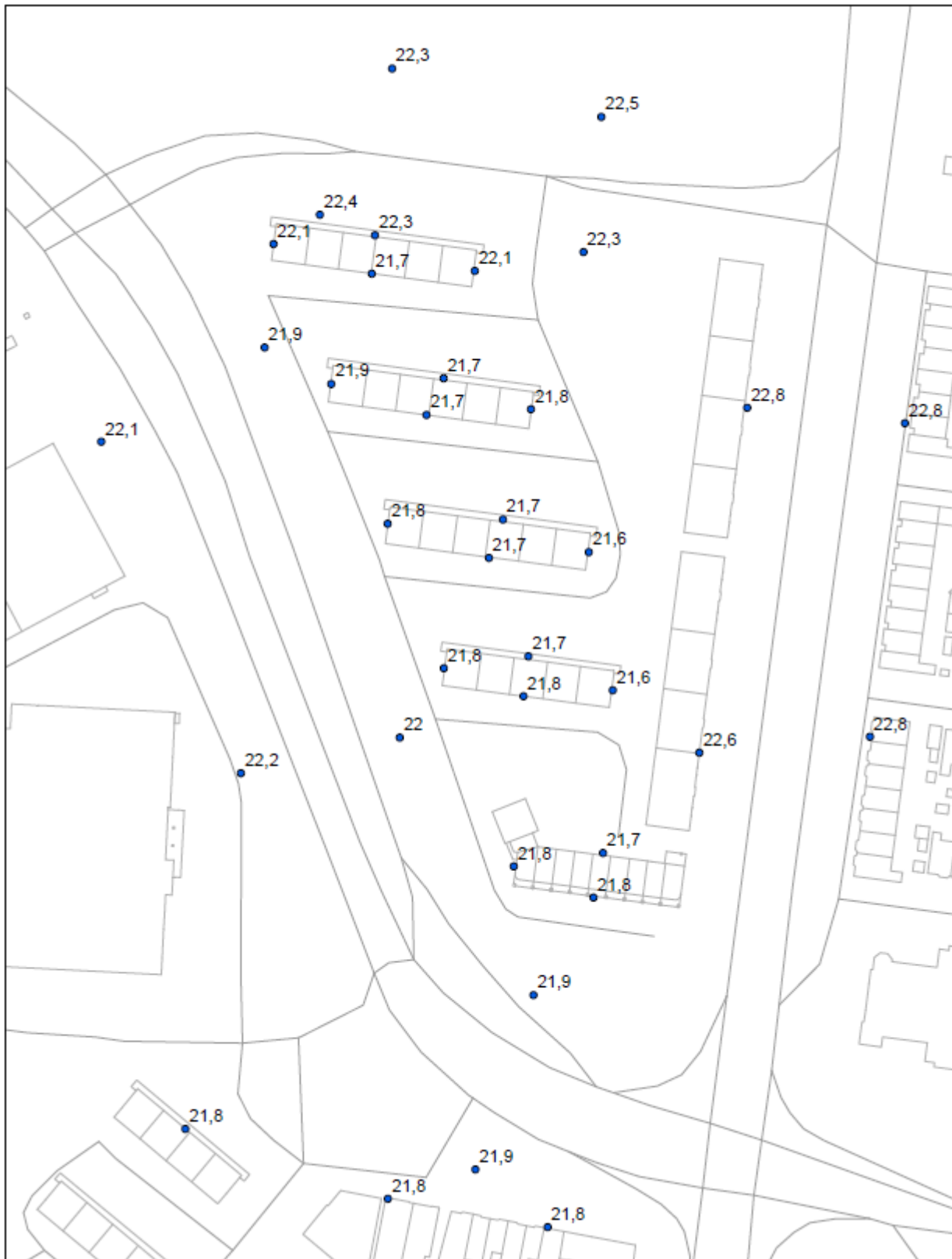
Figuur B4-3: Jaargemiddelde concentratie fijn stof Beoogd Ontwerp 2020 in \mu\text{g}/\text{m}^3
